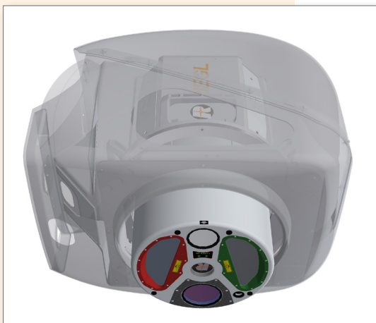
Система RIEGL VQ-1560i-DW установлена в носовом обтекателе самолёта DA42 MPP
