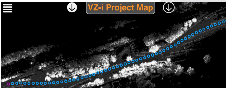
В процессе выполнения полевых измерений, оператор может проверить зарегистрированные позиции сканирования и данные сканирования удаленно через мобильное устройство.
