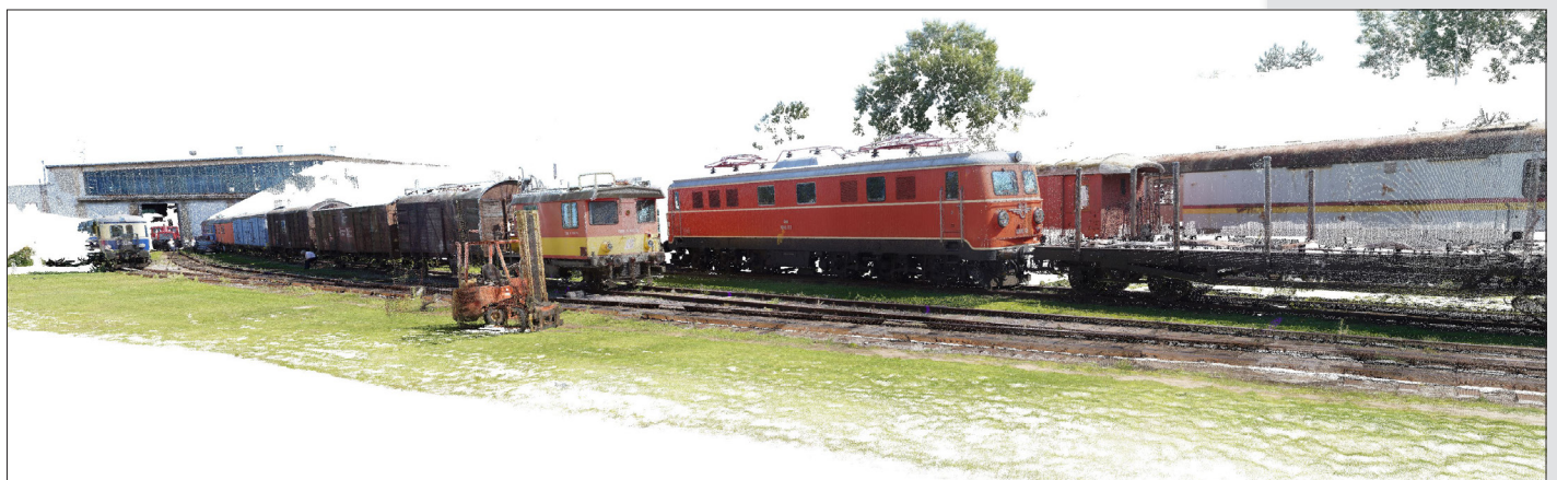
облако точек, окрашенное с помощью фотографий
