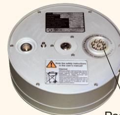
Разъем соединения аккумулятора со сканером
